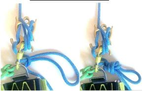
Pour un arrêt prolongé ou mouvementé : rajouter nœud de mule et nœud d'arrêt
