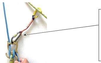
La connexion avec le brin guide de corde se fait avec une dégaine fixée sur le trou supérieur du Cœur.
