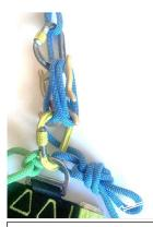
Arrêt prolongé ou mouvementé : ajouter nœud de mule & nœud d'arrêt
