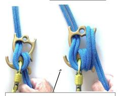
Descente à double, sans et avec frein additionnel, le passage de la corde est en mode rapide (sans utilisation de la corne basale gauche)
